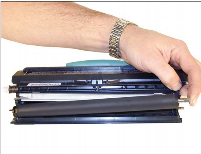
9. Remueva el rodillo revelador. Limpie el rodillo de alimentación con aire comprimido, si tiene disponible.
