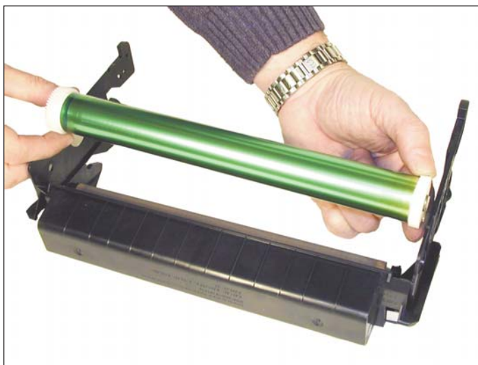
11. Con la c mara de desperdicio viendo hacia usted, instale el cilindro de manera que el engranaje grande este en el lado izquierdo y el resorte del engranaje peque o este viendo hacia abajo.
