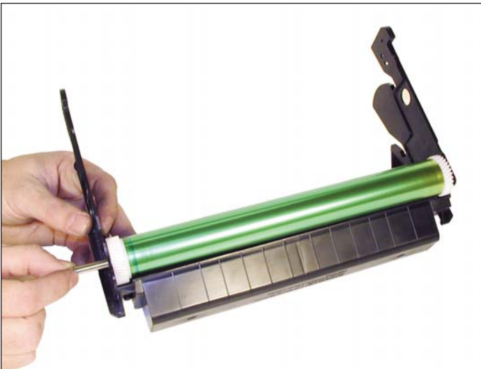
12. Instale el eje del cilindro del lado del engranaje grande.
