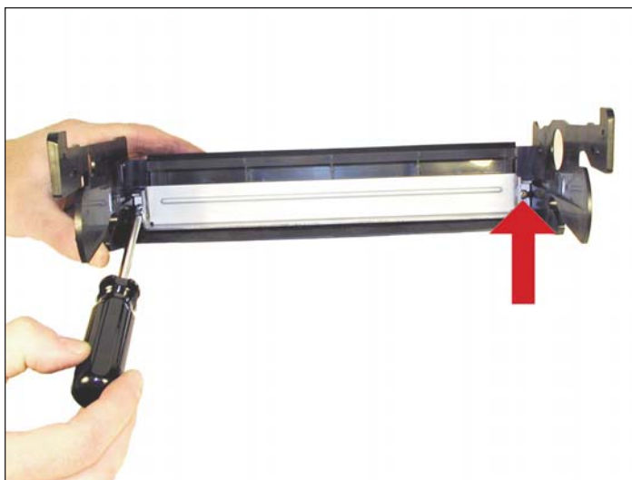
9. Instale una cuchilla limpiadora nueva, c brala con su lubricante preferido y coloque los dos tornillos. Limpie las bases del PCR con alcohol isoprop lico 99% puro. Col quelas al final del PCR.
